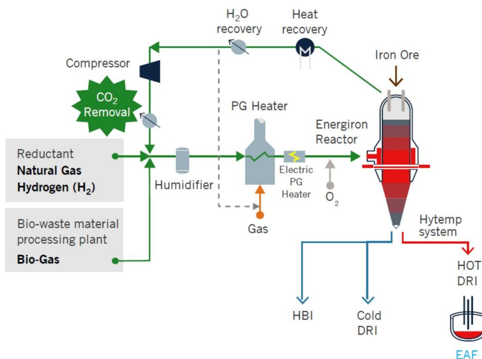
Esistono impianti di produzione di DRI che hanno già effettuato (o stanno implementando<sup>22</sup>) la sostituzione totale del gas naturale con idrogeno e diversi altri progetti attivi che si stanno occupando di mettere in pratica questa tecnologia.
